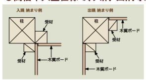
入隅や出隅等で柱に直接木質ボードを施工できない場合、柱に受材を取り付けて施工しますが、この場合、高倍率大壁の倍率(4.3)ではなく、高倍率真壁の倍率(4.0)が適用されますので、注意してください。
